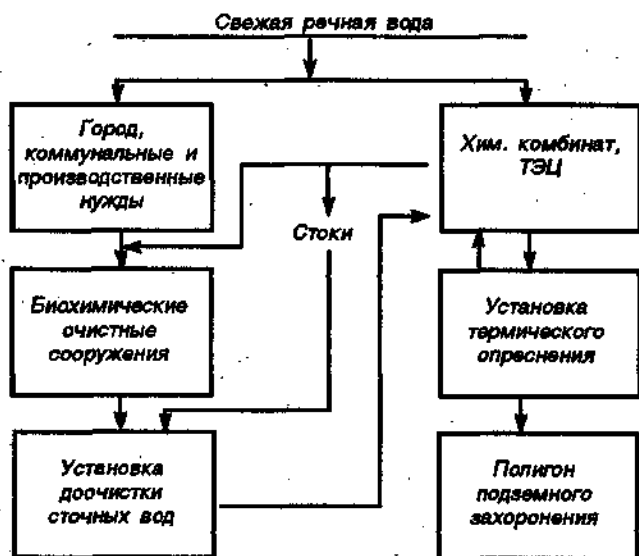
Р и с. 15.7. Замкнутый водооборот на одном из химических заводов
